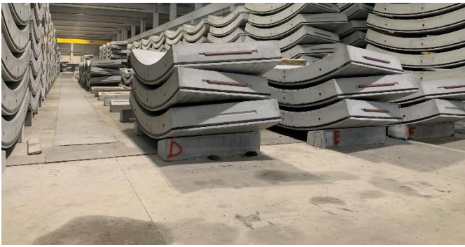
Figura 2 – Produzione conci presso impianto Hinterrigger
